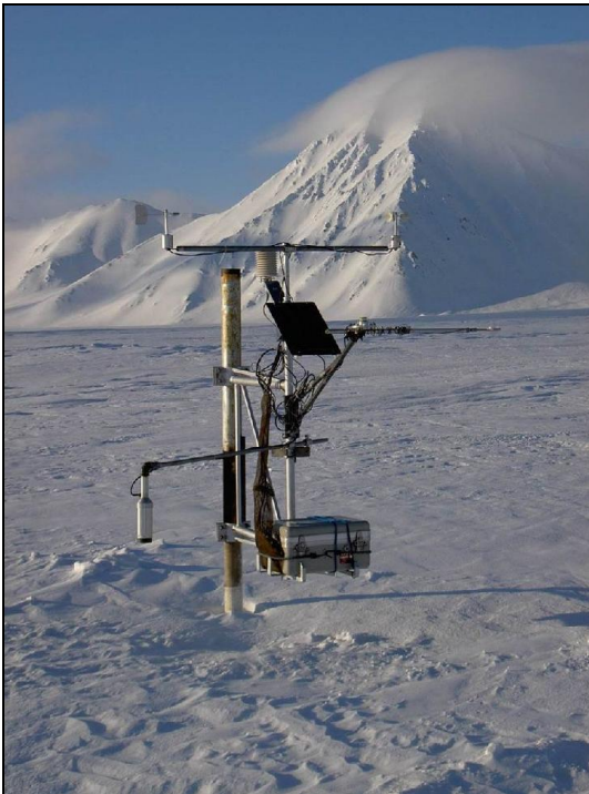
Ryc. 4. Automatyka stacja meteorologiczna w strefie ablacyjnej Lodowca Hansa w 2004 roku
