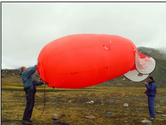
Ryc. 5. Balon meteorologiczny i badania warstwy granicznej atmosfery. Hornsund, 2005
