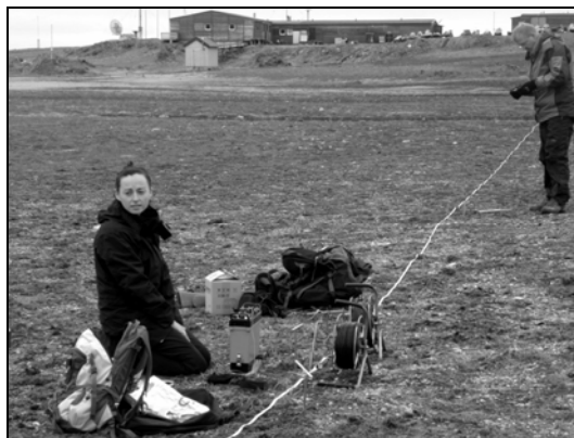
Ryc. 4. Badania elektrooporowe na terasie nadmorskiej w pobliżu Polskiej Stacji Polarnej w lecie 2009 Fig. 4. Electroresistivity research on the marine terrace near the Polish Polar Station in. the summer 2009
